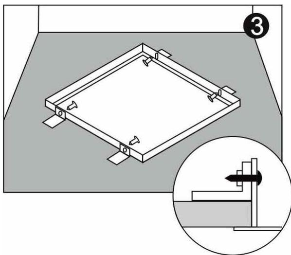
Fixer le cadre dans le plafond avec les vis et les pattes en L
