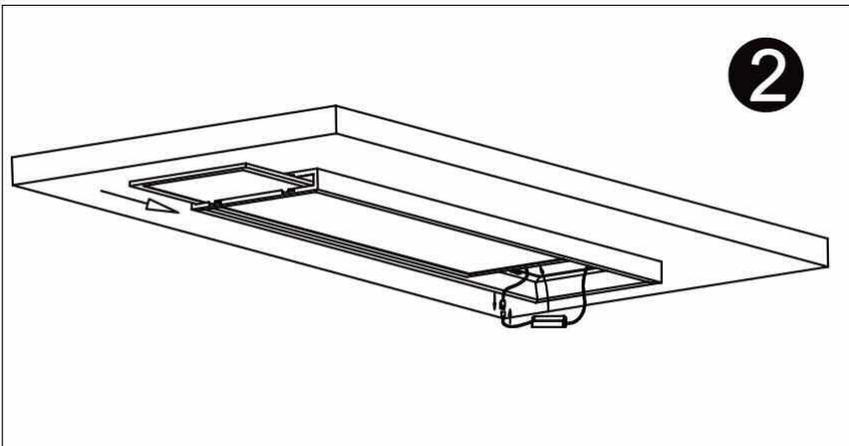
Insérer le panneau PALETO et le raccorder électriquement
