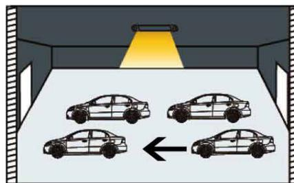
Avec mouvement détecté, l'intensité lumineuse augmentera à 100%
