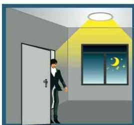
Avec une lumière ambiante insuffisante, l'éclairage se déclenche quand un mouvement est détecté.
