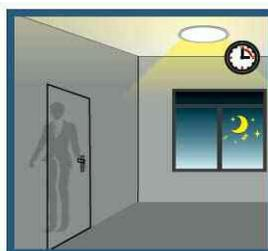
Après la dernière détection de mouvement, l'éclairage est maintenu suivant la durée choisie.
