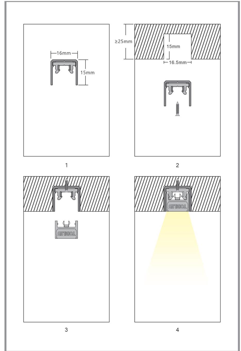
Montage suspension avec rail TORS
