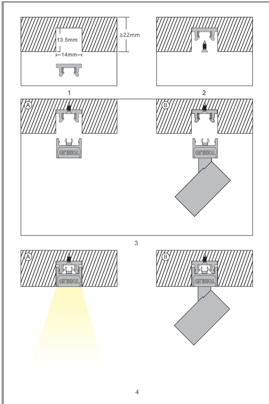
Montage avec rail TORA + vis
