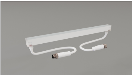
réf: 33715 - 300 mm Indice de protection : IP67 Câblage traversant Connecteurs : mâle et femelle
