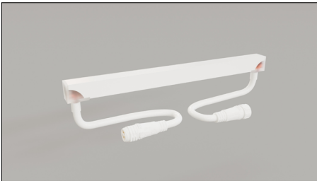
réf: 33615 - 300 mm Indice de protection : IP67 Câblage traversant Connecteurs : mâle et femelle
