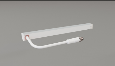
réf: 33503 - 300 mm Indice de protection : IP67 Sens de connexion : Droit Connecteur : Mâle
