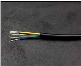
HO5RVV • NOIR Dimension: ø6,5 mm Section: 6 x 0,5 mm Référence: 90132
