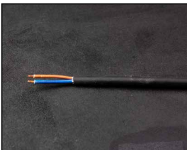
HO5RRF • NOIR Dimension: ø6mm Section: 2 x 0,75mm Référence: 90120
