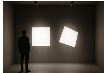
Les couteaux de cadrage permettent un réglage fin du faisceau lumineux par masquage partiel, offrant une adaptation précise à la géométrie de l'œuvre. Ils autorisent la création de découpages nettes : rectangles, lignes, carrés ou formes triangulaires.
