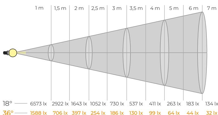
Le zoom permet de générer des faisceaux circulaires de différents diamètres, tandis que la bague d'ajustement assure une mise au point précise. Cette fonctionnalité est idéale pour l'intégration de gobos.
